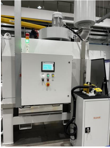
冷凝+玻璃纤维过滤装置
