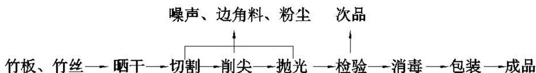
图 3-22 生产工艺流程
