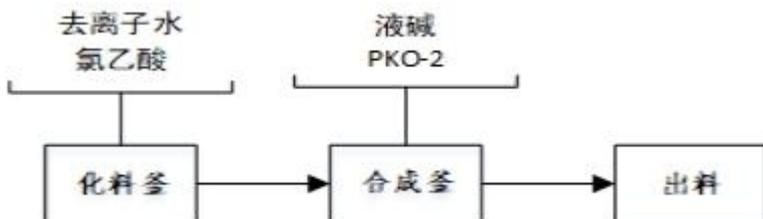
图 3-14 表面活性剂系列产品配套氯乙酸化料工艺流程图
