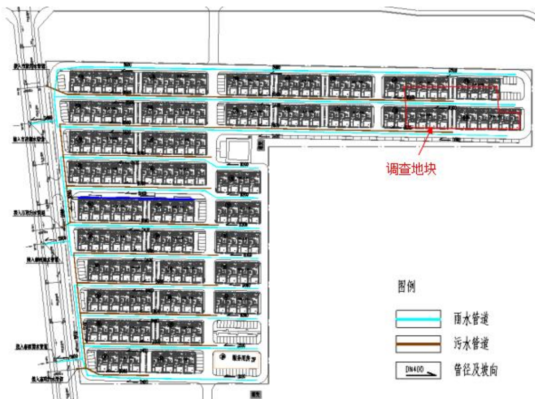
图 3-8 地块雨水及生活污水管线图
