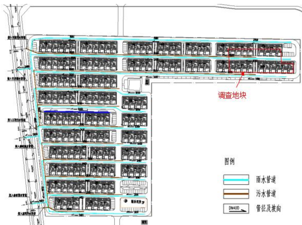
图 3-12 地块雨水及生活污水管线图
