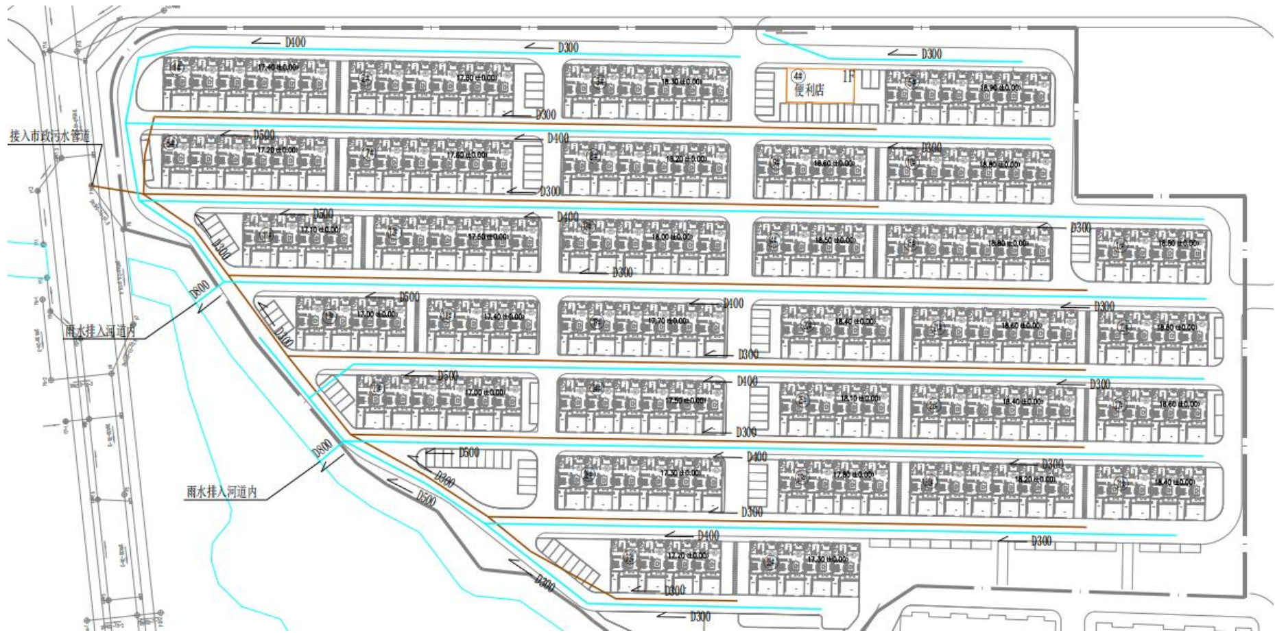
图 3-12 地下管网布设图
