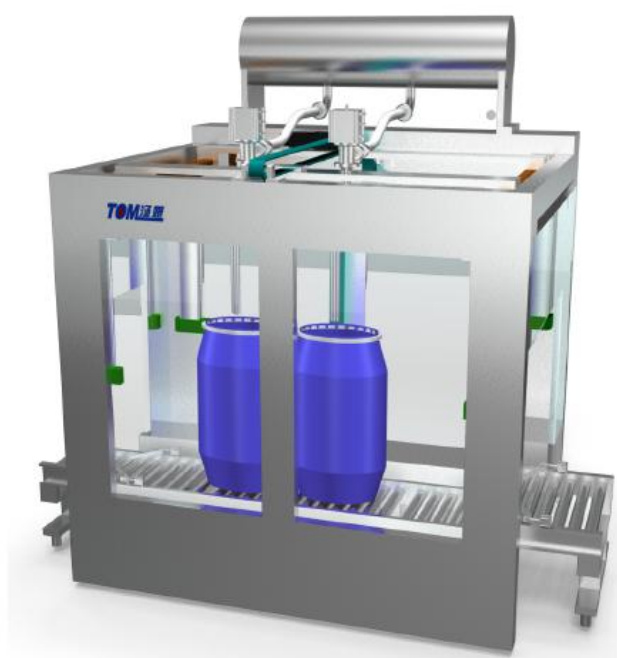
自动灌装(灌装区域密闭微负压，顶部有排风口，废气接至处理设施内)
