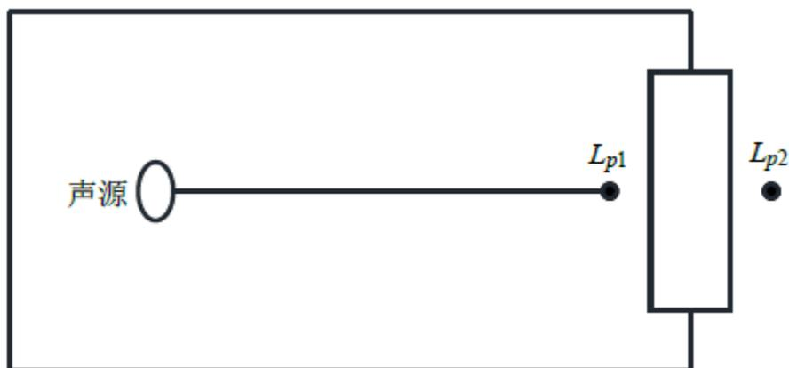
图6.5-1 室内声源等效为室外声源图例
