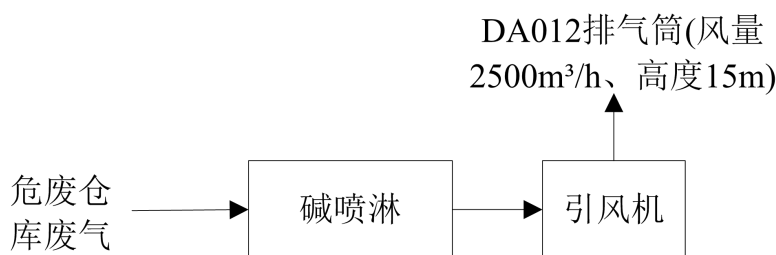
图 6.1-7 危险废物贮存库废气净化工艺流程图
