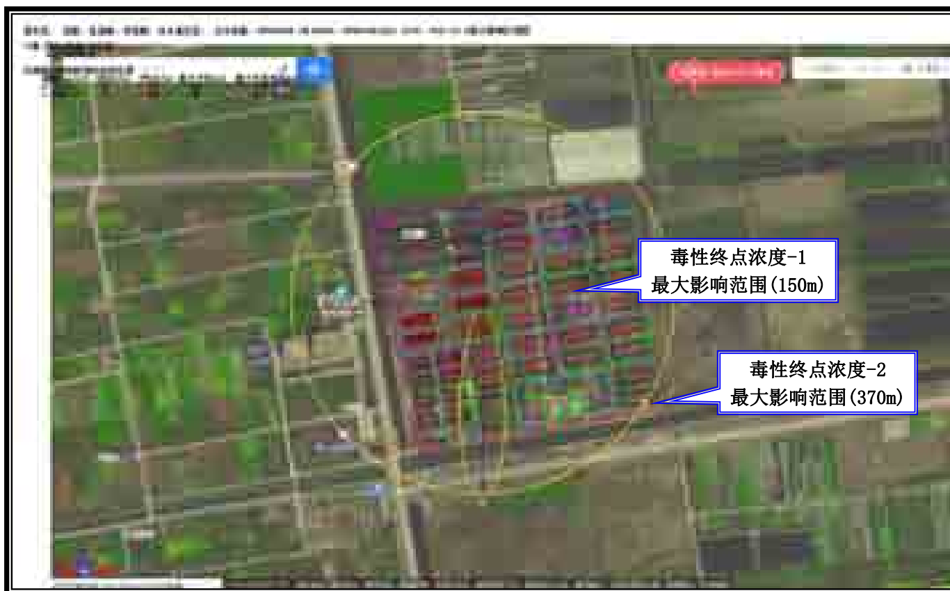
图 5.9-19 最常见气象条件下盐酸储罐泄漏预测结果图
