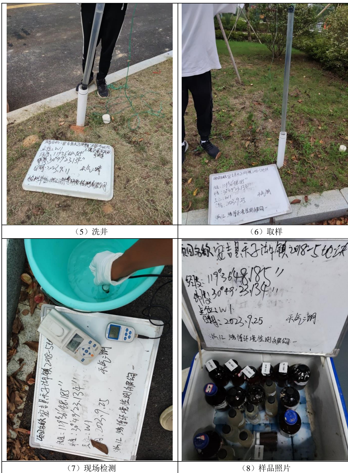
图5-5部分地下水建井、洗井、检测照片
